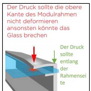
Abbildung 1a: Druck auf die Klemmenstellen
